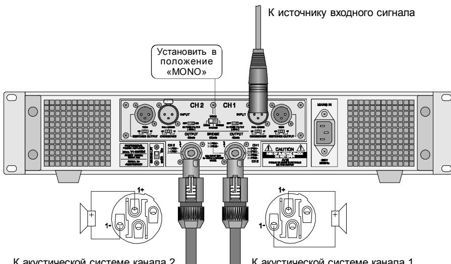
емый контакт 3 (Сигнал«—») соединителя XLR должен быть обязательно соединен с земляным контактом 1 (Общий). Не располагайте входные кабели в непосредственной близости от сетевых кабелей и силовых трансформаторов.
