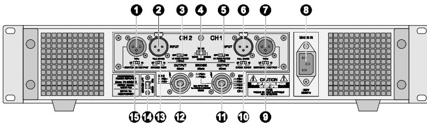
**① ⑦ SWITCHED OUTPUT** (переключаемый выход) – линейные выходы. Предназначены для подачи сигнала на вход другого усилителя (при работе нескольких усилителей от одного источника входного сигнала).
