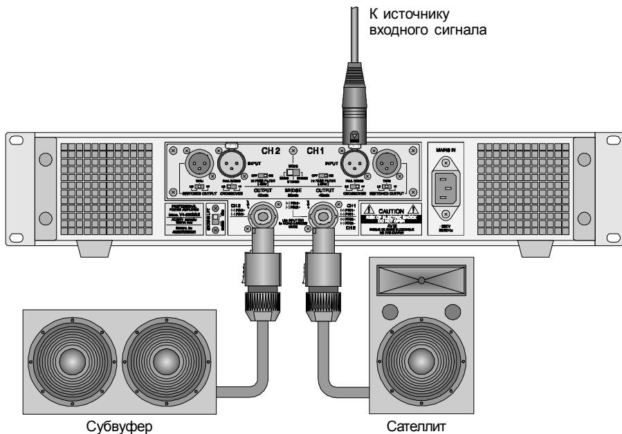
**Установки кроссовера при работе усилителя в составе двухполосного монофонического комплекса**
