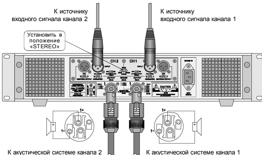
**Подключение сигнала и акустических систем
