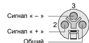
Для подведения к усилителю входного сигнала используйте только экранированные кабели, независимо от того симметричные они или нет. Не располагайте входные кабели в непосредственной близости от сетевых кабелей и силовых трансформаторов.
